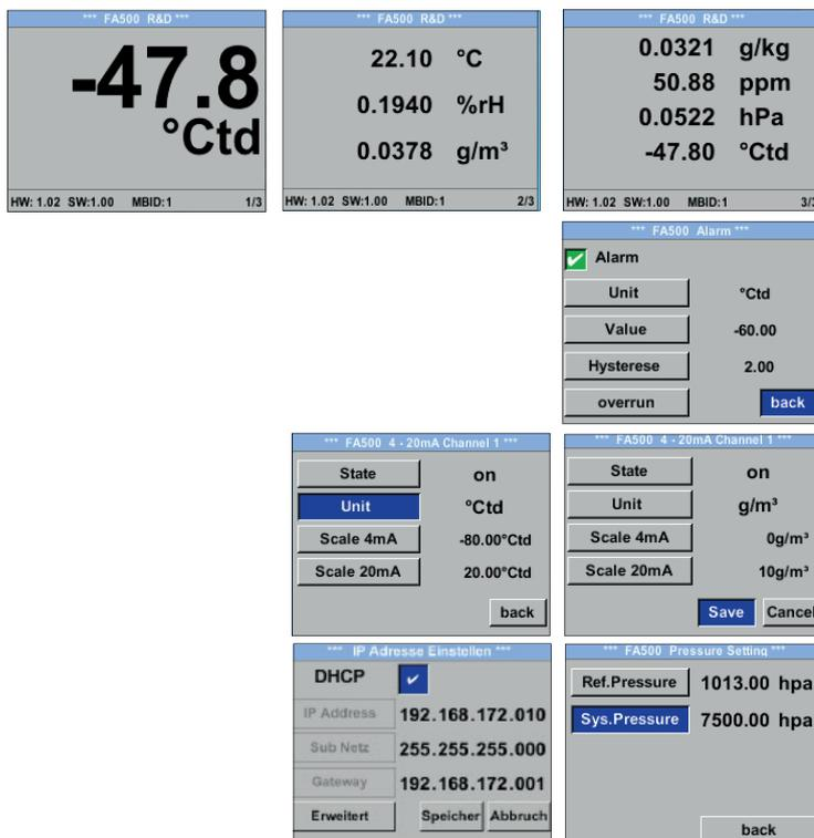
La pantalla integrada muestra el punto de rocío en grande y las demás magnitudes de humedad en otras 2 ventanas de la pantalla. Con la flecha se puede cambiar de una ventana a otra.
