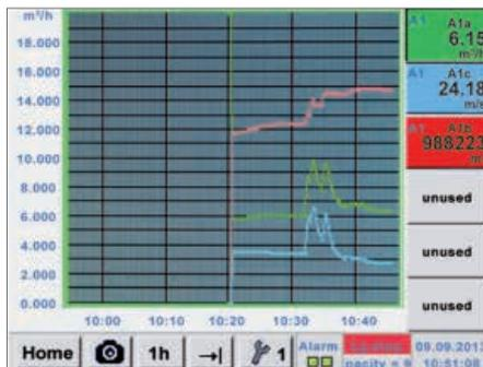
Así, el usuario puede ver en cualquier momento las curvas de medición guardadas sobre el terreno. Eso permite un análisis rápido y sencillo del aire comprimido o del consumo de gas.
