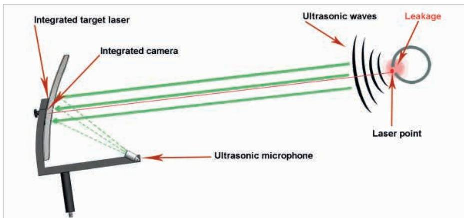
Con la agrupación de las ondas de ultrasonido en el espejo parabólico se pueden detectar incluso las fugas de menos de 0,8 l/min (aprox. 8 € p. a.) a una distancia de 10 a 15 m con un alto nivel de precisión ( $\pm 15$  cm).
