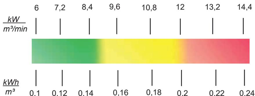
Una demanda típica de potencia específica de un compresor de inyección de aceite puede ser como se observa a continuación:
