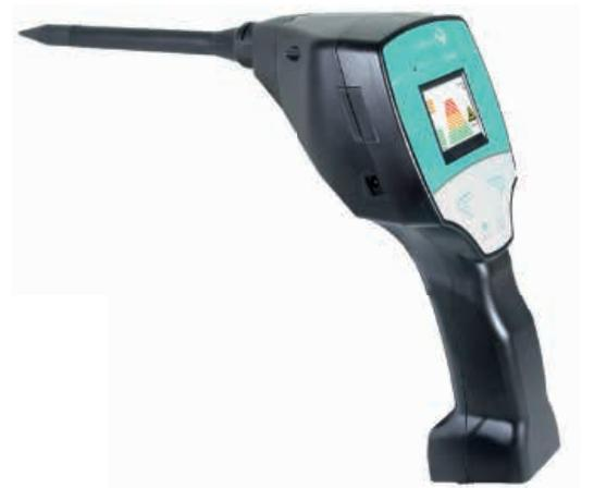
**LD 400** con tubo de enderezamiento con punta de referencia para la localización exacta.
