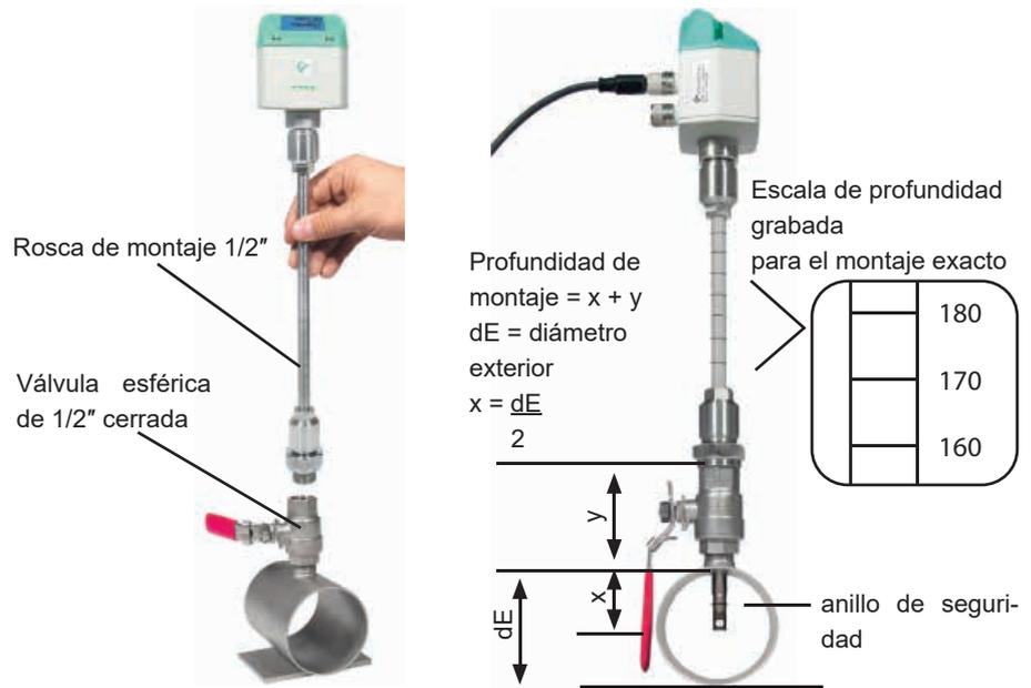
2) Si no hay ningún punto de medición con válvula esférica de 1/2" adecuado hay dos posibilidades sencillas de elaborar un punto de medición:
