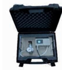
Medición de la calidad del aire comprimido
