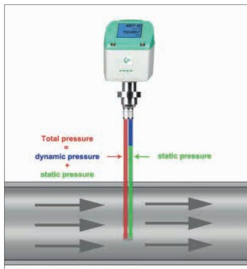
La presión diferencial/dinámica en la punta del sensor se mide mediante el sensor diferencial de precisión integrado. Este depende de la velocidad de gas correspondiente. Con el diámetro de tubo es posible calcular fácilmente el caudal.
