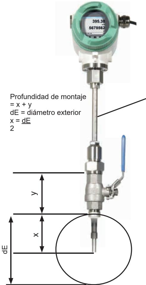
Escala de profundidad grabada para el montaje exacto
