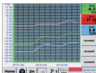
Las curvas de medición se muestran en gráficos. Por lo que el operario ve de un vistazo el comportamiento del secador desde el inicio de la medición.
